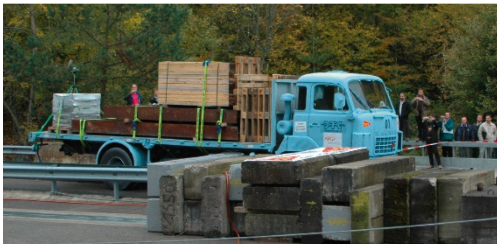
Ladungssicherung : formschlüssig, gebündelt, mit Zurrgurten gesichert
